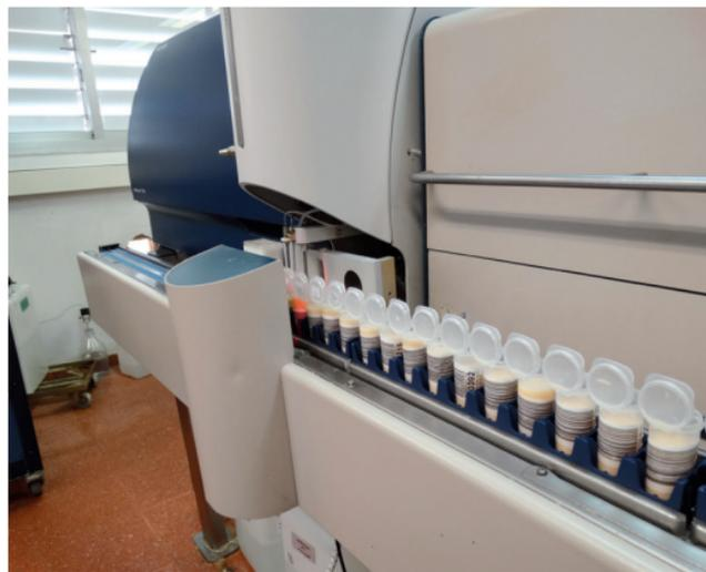
**Figura 2.2.** Amostragem pelo equipamento automatizado para determinação da CCS.
