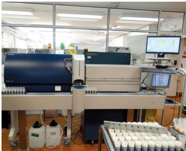
**Figura 2.1.** Equipamento automatizado para determinação da CCS.
